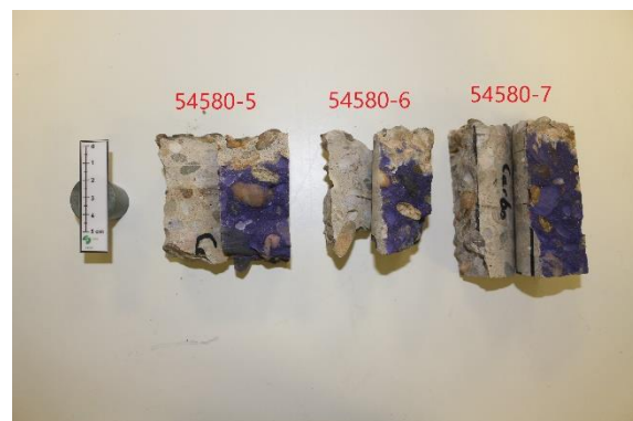
Fig. 85 : Carbonatation du béton sur les échantillons 54580-5 à 7
