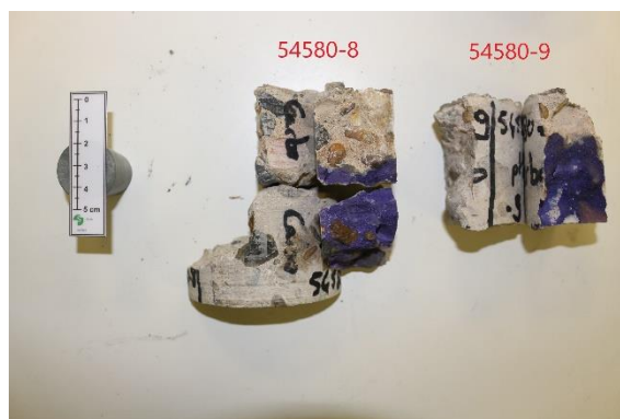
Fig. 86 : Carbonatation du béton sur les échantillons 54580-8 et 9
