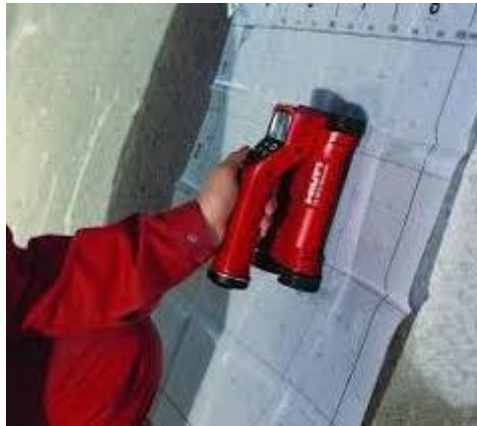
Fig. 20 : Illustration maillage au Ferroskan
