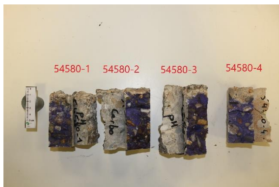
Fig. 84 : Carbonatation du béton sur les échantillons 54580-1 à 4
